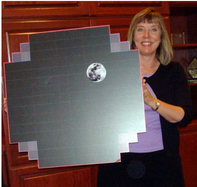
Esquema de montagem dos 189 CCDs mostrando imagem da Lua no campo de visão
